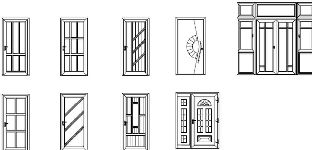
Рисунок 9 – Примеры архитектурных рисунков дверных блоков с декоративным заполнением дверных полотен
