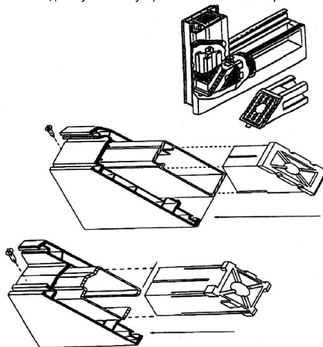
Рисунок 5 – Примеры установки угловых усилителей (вкладышей)
