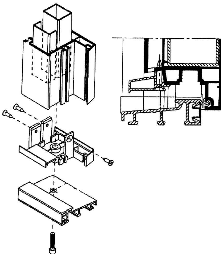
Рисунок 7 – Примеры крепления порогов (механическое соединение)
