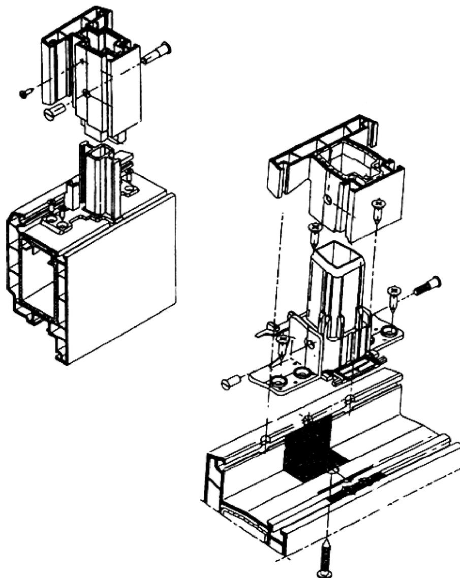
Рисунок 6 – Примеры крепления импостов (механическое соединение)
