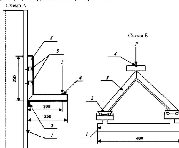
1 – опора; 2 – упор (для схемы Б каретки); 3 – образец;
