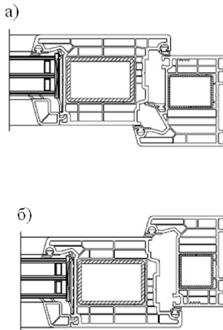
а) дверная система с тремя контурами уплотнения; б) дверная система с двумя контурами уплотнения
