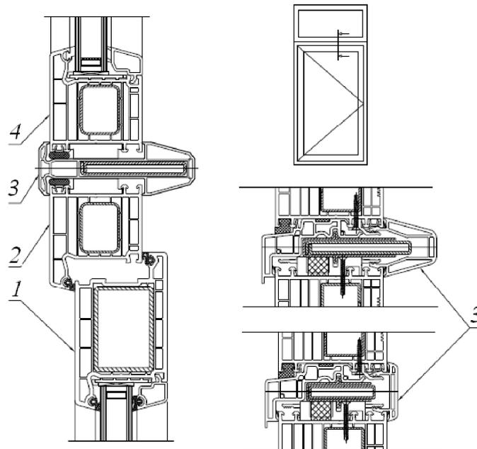
1 – полотно дверного блока; 2 – коробка дверного блока; 3 – соединители;
